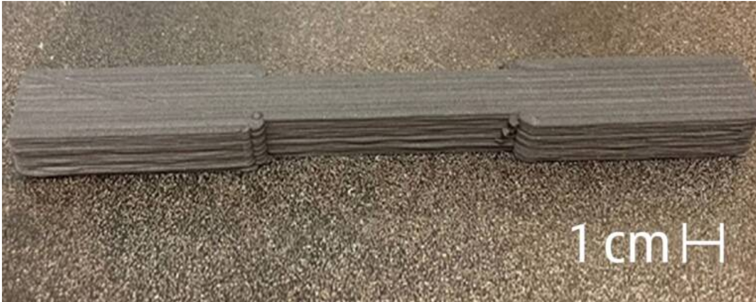
Figure 5. Éprouvette de traction en Ti6Al4V avant usinage, délaminage et frittage[1]
